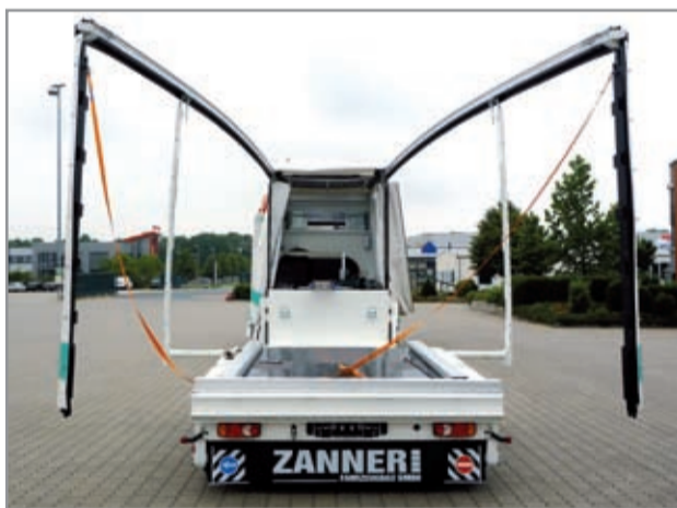
Fertig für die Beladung per Kran auf ganzen 4,0 m Breite.
