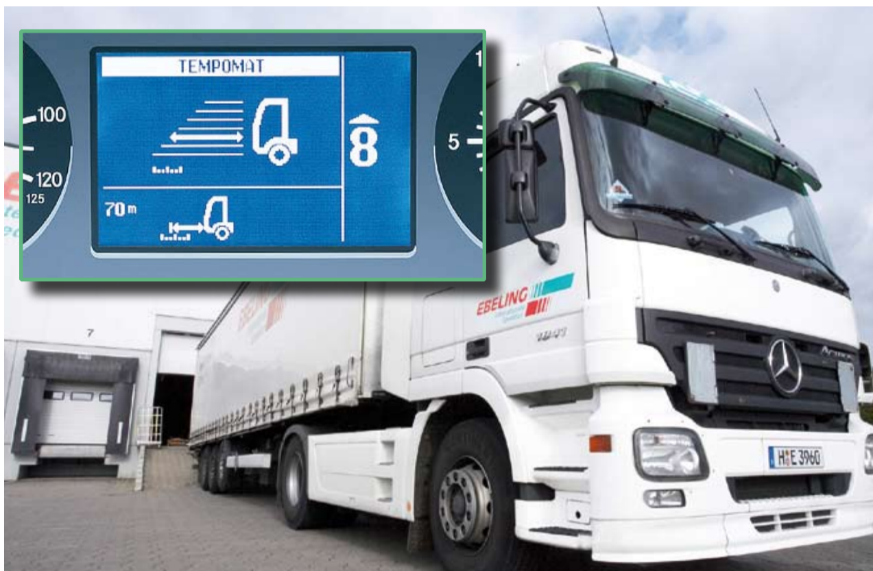
Die neue LKW-Generation mit vielen Sicherheitsfeatures wie Abstandsregler, Spurassistent und Wankregelung.
