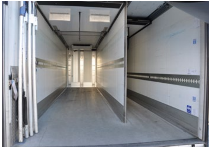
Einblick in den Aufbau mit zwei verschiedenen Kühlzonen.
