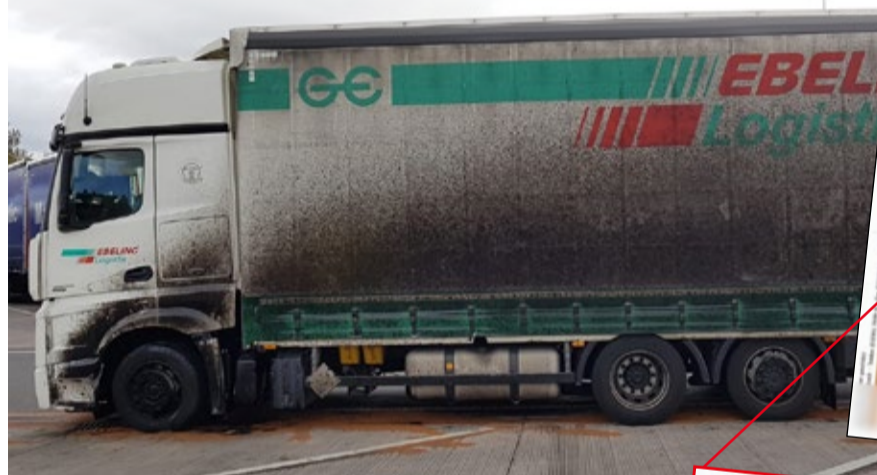
So sieht es aus, wenn während der Fahrt ein Ölschlauch platzt.
