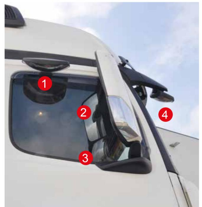
Vier Spiegel ermöglichen bisher die Reduzierung der toten Winkel nach rechts und vorne
